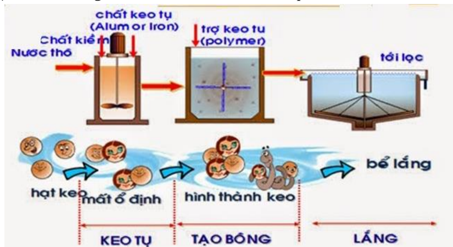
Hình 3.8. Cơ chế quá trình keo tụ - tạo bông
