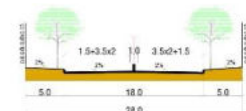
5A-5A TRỤC BẮC NAM SỐ 1 (ĐOẠN TỪ ĐT.638 ĐẾN CẦU MỚI) ĐT.638 (TỪ QL.19 QUA NHƠN LỘC ĐẾN NHƠN PHÚC)
